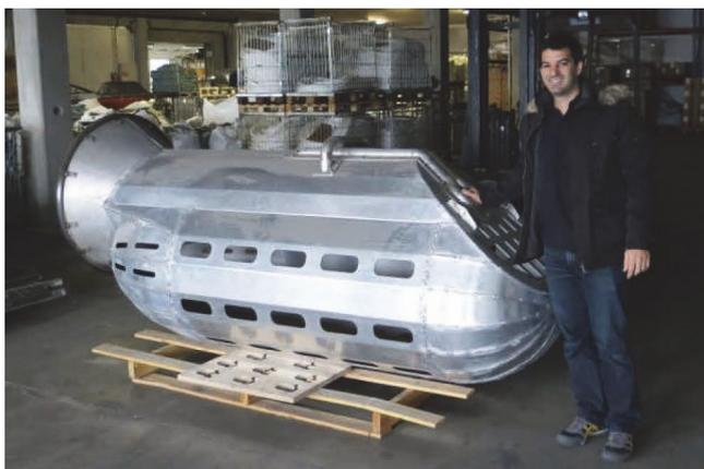
Рисунок 5 – Устройство для накопления улова в размещении с размерами человека
